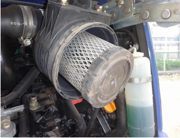
エアエレメント状況
