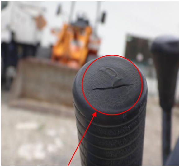
ホーンボタンカバー損傷有り。
