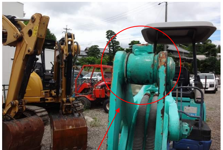
アームシリンダーパッキンひび割れ有り。
